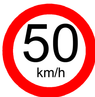
Figura 44: Placa de regulamentação de velocidade máxima (R-19)
